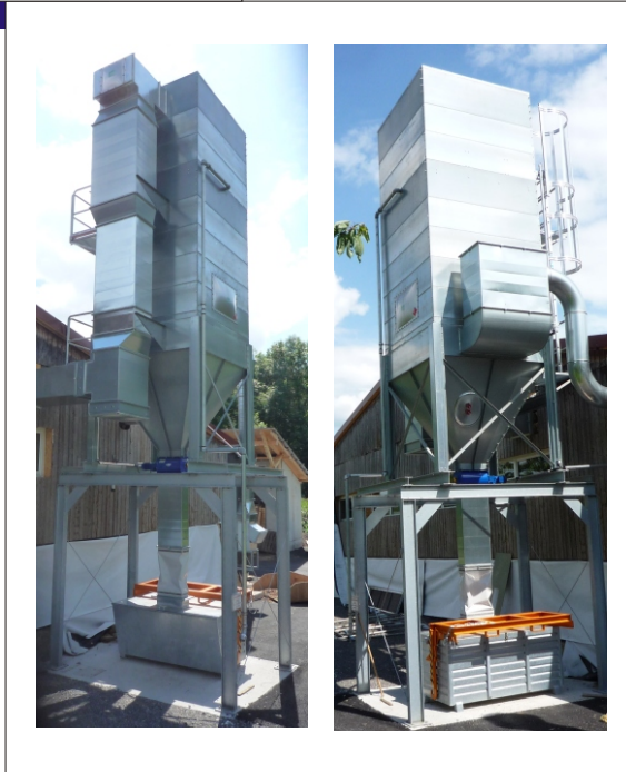
Abbildung mit Modul-Schleusenfilter Typ MSF (Laufsteg, Unterkonstruktion und Container sind Zubehör)
