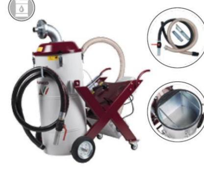
FROG ist ein **einphasiger** Industriesauger und wurde zur **Trennung der Flüssigkeiten von den Feststoffen** entwickelt. Die serienmäßige Ausrüstung **ermöglicht eine Beschleunigung der Reinigungsvorgänge** in den Arbeitsbereichen und die Wiederverwendung der emulgierten Öle und Kühlmittel. **Fassungsvermögen 130 Liter.**
