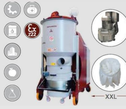
Der Industriesauger PUMA 30 und PUMA 35 ist serienmäßig mit einer dreiphasigen Hochleistungsturbinen, elektrischer Filterrüttelvorrichtung und großzügig ausgelegter Filterkammer ausgestattet. Optional kann dieses Modell mit einer Druckluftabreinigung und Filterpatronen vorgesehen werden. Haupteinsatzgebiete sind anspruchsvolle Anwendungen im Industriebereich und bei Dauerbetrieb. Vorteilhaft trotz seiner Dimension ist die hohe Saugleistung und leichte Beweglichkeit.
