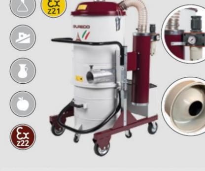
Der Druckluft-Industriesauger AC wurde für den Einsatz in Bereichen entworfen, in denen die Benutzung von Strom gefährlich ist. Das Gerät ist mit einem **leistungsstarken Venturi-System** und einem Standardfilter der Klasse "M" ausgestattet und kann sowohl Flüssigkeiten als auch Feststoffe aufsaugen. Auf Wunsch ist der Sauger auch mit **Absolutfilter HEPA 14 (H99.995%)** lieferbar. Eine zertifizierte Version gemäß den Richtlinien ATEX Staub Zone 21-22 und Gas Zone 2 ist verfügbar.
